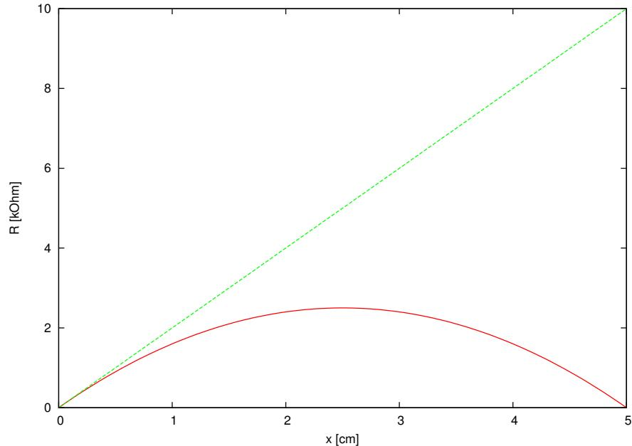
ii) Polna (rdeča) črta kaže spremenjanje moči med A in B za potenciometer a), črtkana (zelena) za potenciometer b):
