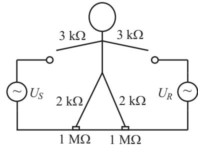
Predpostavi, da je upor roke  $3 \text{ k}\Omega$ , upor noge  $2 \text{ k}\Omega$ , upor trupa lahko zanemariš. Upoštevaj, da je elektroinštalater obut in se z obema nogama dotika tal, vsak izmed obeh čevljev pa ima upor  $1 \text{ M}\Omega$ . Amplitudi napetosti  $U_R$  in  $U_S$  sta  $320 \text{ V}$ , medfazna napetost  $U_R - U_S$  pa ima amplitudo  $550 \text{ V}$ .
